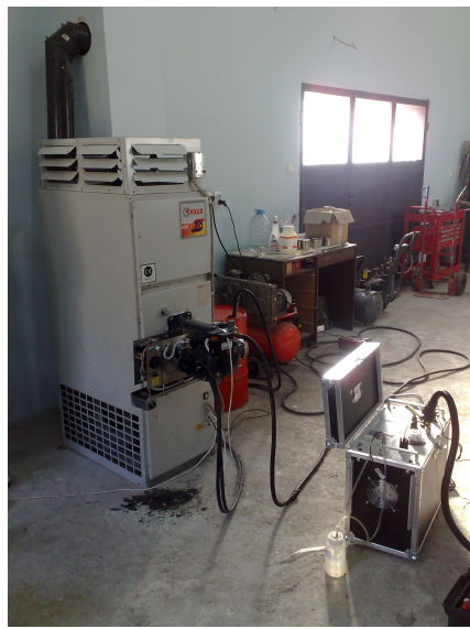
Слика 2. Котао типа “B23”, произвођача “GENERATORE D’ARIA LALDA”
