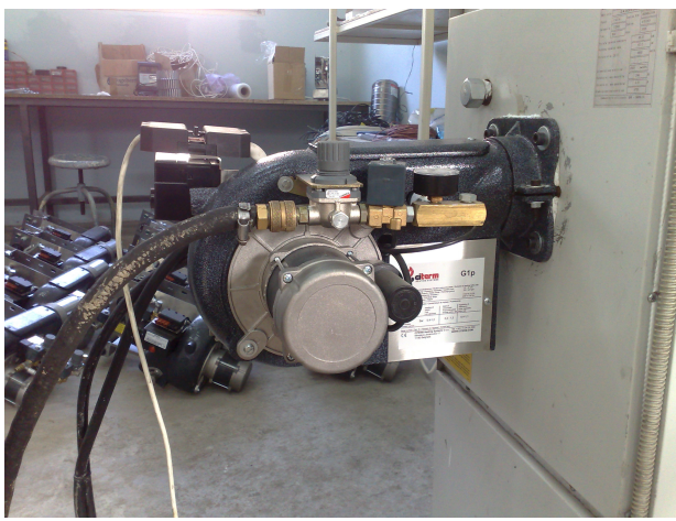
Слика 3. Горионик типа G1P, произвођача „CITERM HEATING SYSTEMS“
