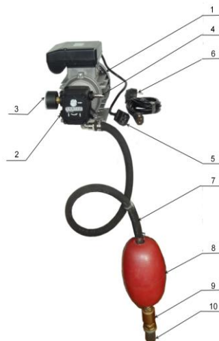
Рис.14. Топливный насос в сборе.
