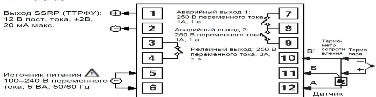
Рис. 9. Электрическая схема температурного контроллера.
